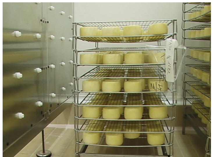
Mognadssystem för ostar med djupdiffusion av luften och föroreningskontroll.
